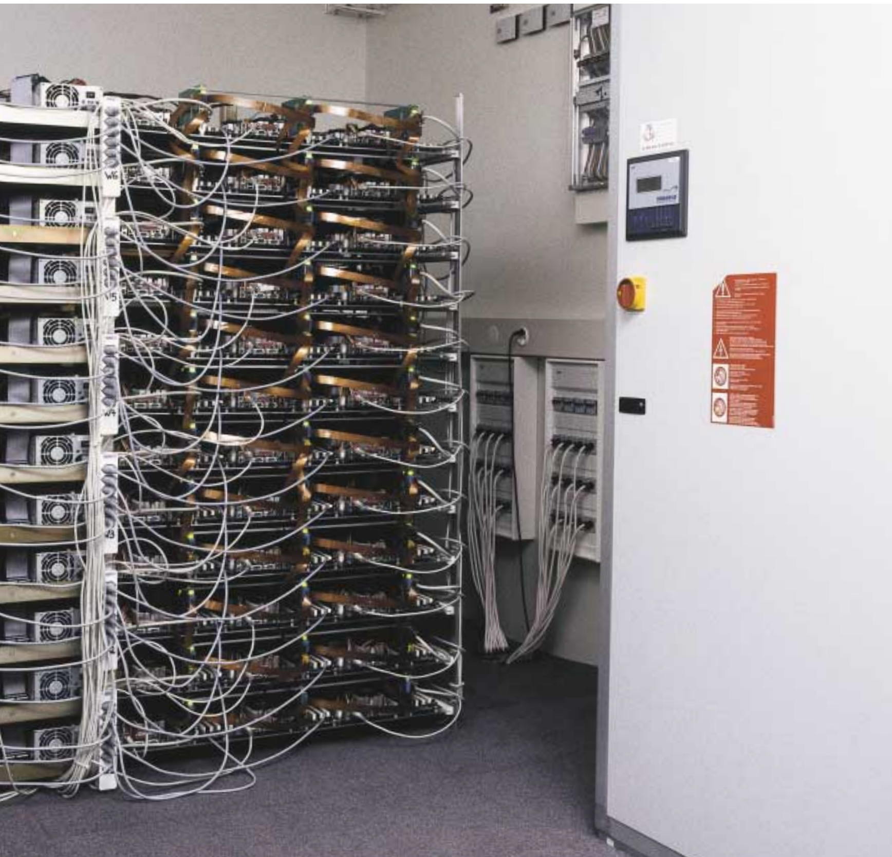
Theoretische Physik besteht aus 144 Hauptplatinen mit jeweils zwei Prozessoren, wie man sie in den besten PC findet.
